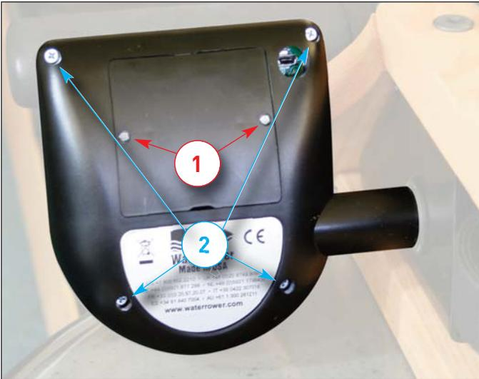
2. Drehen Sie nun die 4 äußeren Schrauben der Monitorrückseite heraus. Nehmen Sie anschließend die Rückwand des Monitors ab. Sie haben nun freie Sicht auf die Monitorplatine.
